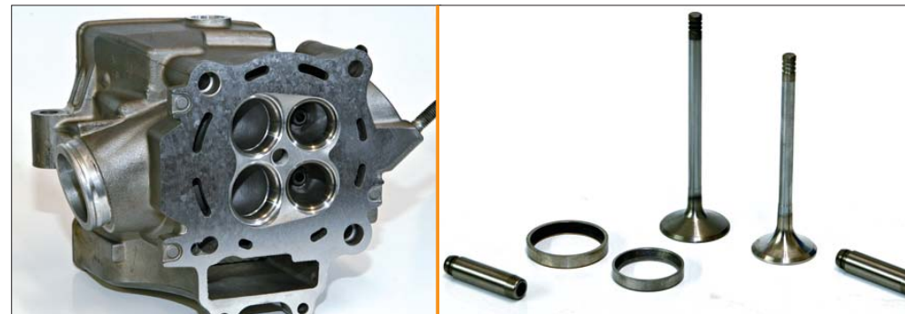
SEDI VALVOLA RECUPERATE A NUOVO ACCANTO A UNA COPPIA DI VALVOLE CON RELATIVE GUIDE E SEDI. Le sedi sono degli anelli in metallo duro (molto spesso sinterizzato) dove vanno a fare tenuta le valvole richiamate del carico delle molle.
